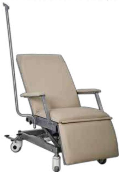
Fabrique en tube d'acier, composé d'une potence à sérum, et de deux accoudoirs. Le dossier et le relève jambes sont articulés par un vérin à gaz. Hauteur réglable par un système hydraulique. Doté de 4 roues à frein diamètre 125 mm. Texture en simili cuir lavable. Peinture « époxy ».
