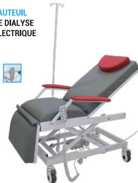
Fabrique en tube d'acier, composé d'une potence à sérum. dossier, relève jambes et la hauteur sont articulés par un système électrique télécommandé. Doté de 4 roues à frein diamètre 125mm. Texture en simili cuir lavable. Peinture « époxy ».
