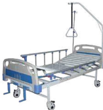
Fabriqué en tubes d'acier rectangulaire 30 x 60 mm et en tôle métallique, composé d'un dossier et relève jambes articulés par deux manivelles multi-positions, montants ABS, barrières de sécurité en aluminium rabattables; une potence ; et un perroquet. Doté de quatre roues à frein de diamètre 125 mm. Peinture « époxy ».
