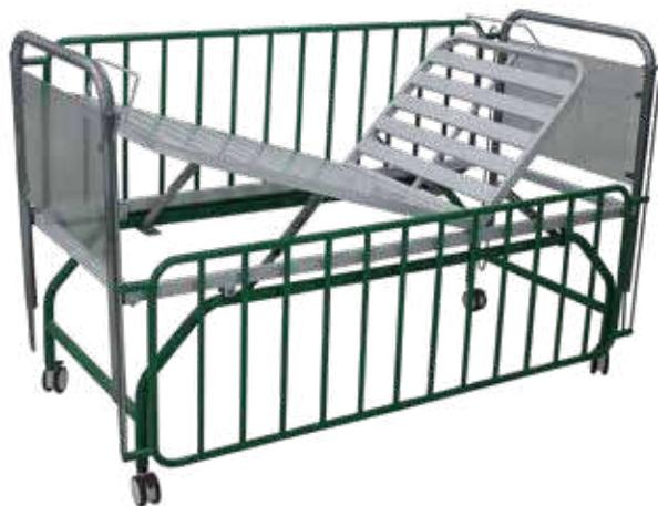
Fabriqué en tube d'acier rond de diamètre 32 et en tôle métallique, composé d'un dossier et relève jambes articulés par un système mécanique, et d'une ridelle mouvante verticale, montants en plexiglas. Il est doté de quatre roues à frein de diamètre 80 mm. Peinture « époxy ».
