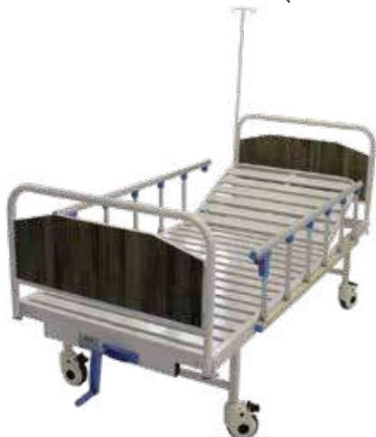
Fabriqué en tubes d'acier rectangulaire 30 x 60 mm et en tôle métallique composé d'un dossier articulé par une manivelle montants en tube d'acier rond diamètre 32, support en mélaminé barrières de sécurité en aluminium rabattables ; et une potence ; doté de quatre roues à frein de diamètre 125 mm.
