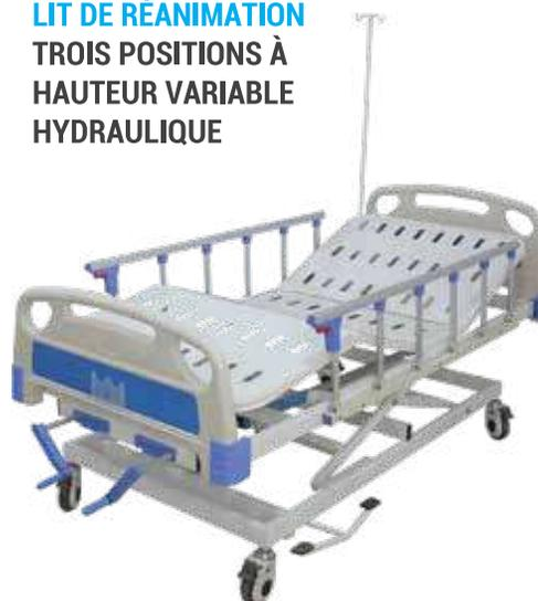
Fabriqué en tubes d'acier rectangulaire 30 x 60 mm et en tôle métallique, composé d'un dossier et plicature de genoux articulés par deux manivelles multi-positions, hauteur variable réglable par un système hydraulique, montants ABS, barrières de sécurité en aluminium rabattables; une potence; doté de quatre roues à frein de diamètre 125 mm. Peinture « époxy ».
