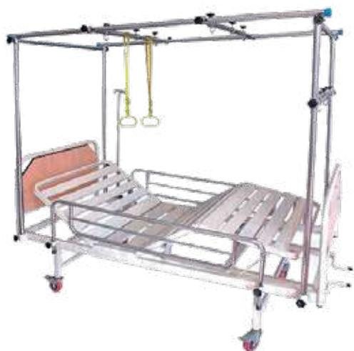
Fabriqué en tube d'acier rectangulaire et tôle métallique, composé d'un dossier et plicature de genoux articulés par deux manivelles multi-positions, de montants en tube d'acier rond diamètre 32, support en mélaminé, barrières de sécurité en acier rabattables, d'un cadre de traction orthopédique en acier chromé de diamètre 32, et de quatre roues avec frein de diamètre 125 mm. Peinture « époxy ».
