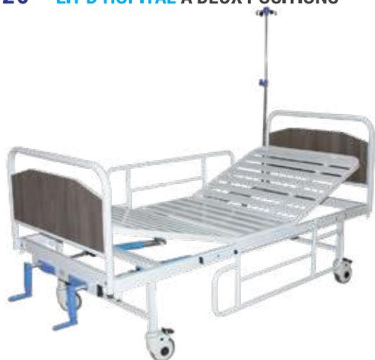
Fabriqué en tubes d'acier rectangulaire 30 x 60 mm et en tôle métallique, composé d'un dossier et relève jambes articulés par deux manivelles multi-positions, montants en tube d'acier rond diamètre 32, support en mélaminé, barrières de sécurité en acier rabattables ; une potence ; doté de quatre roues à frein de diamètre 125 mm. Peinture « époxy ».
