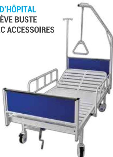
Fabriqu  en tubes d'acier rectangulaire 30 x 60 mm et en t le m tallique, compos  d'un dossier articul  par une manivelle, montants en tube d'acier rond diam tre 32, support en m lamin , barri res de s curit  en acier rabattables, une potence ; et un perroquet ; dot  de quatre roues   frein de diam tre 125 mm. Peinture «  poxy ».
