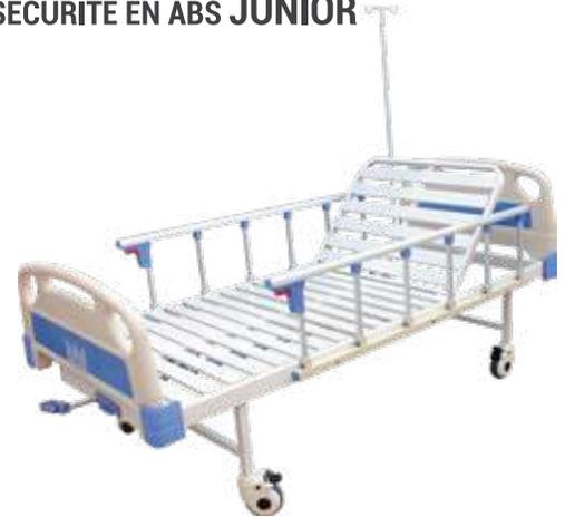
Fabriqué en tubes d'acier rectangulaire 30 x 60 mm et en tôle métallique, composé d'un dossier articulé par une manivelle, montants en ABS, barrières de sécurité en aluminium rabattables, une potence ; doté de quatre roues à frein de diamètre 125 mm. Peinture « époxy ».
