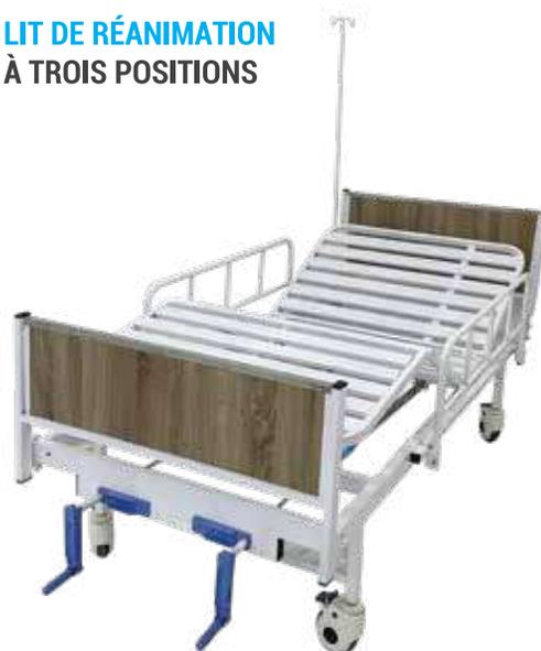
Fabriqué en tubes d'acier rectangulaire 30 x 60 mm et en tôle métallique, composé d'un dossier et plicature de genoux articulés par deux manivelles multi-positions, montants en tube d'acier rond diamètre 32, support en mélaminé, barrières de sécurité en acier rabattables ; une potence. Doté de quatre roues à frein de diamètre 125 mm. Peinture « époxy ».
