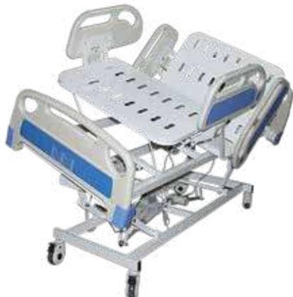
Fabriqué en tubes d'acier rectangulaire 30 x 60 mm et en tôle métallique, composé de : relève buste, plicature de genoux, hauteur variable, proclive, décline, position latérale droite ; position latérale gauche : 7 fonctions actionnées par une télécommande (système électrique), montants ABS, 4 barrières de sécurité en ABS rabattables ; une potence ; doté de quatre roues à frein de diamètre 125 mm. Peinture « époxy »
