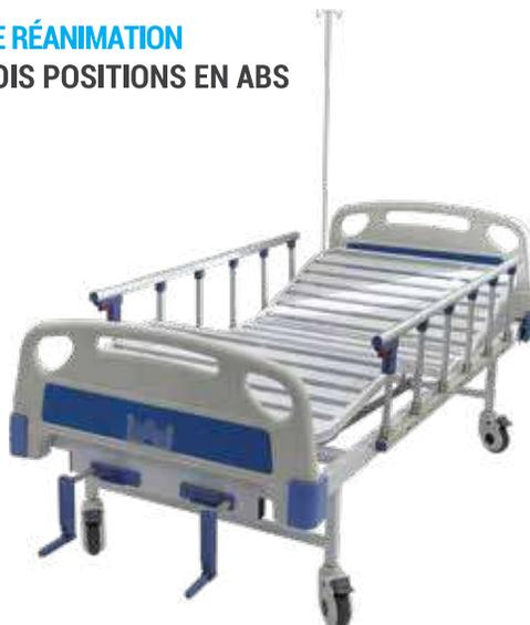
Fabriqué en tubes d'acier rectangulaire 30 x 60 mm et en tôle métallique, composé d'un dossier et plicature de genoux articulés par deux manivelles multi-positions, montants ABS, barrières de sécurité en aluminium rabattables; une potence; doté de quatre roues à frein de diamètre 125 mm. Peinture « époxy ».
