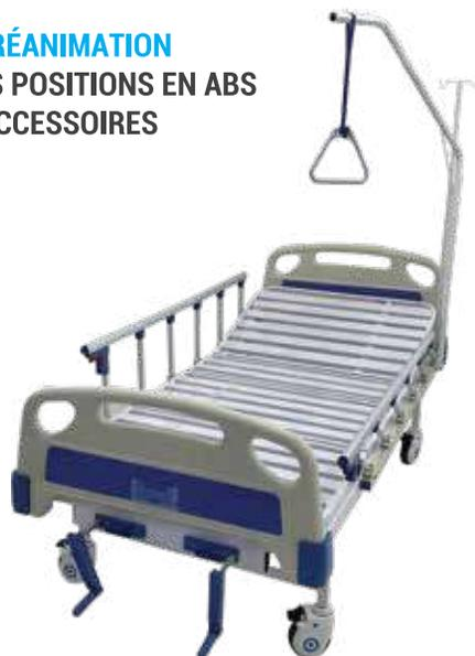
Fabriqué en tubes d'acier rectangulaire 30 x 60 mm et en tôle métallique, composé d'un dossier et plicature de genoux articulés par deux manivelles multi-positions, montants ABS, barrières de sécurité en aluminium rabattables; une potence; et un perroquet; doté de quatre roues à frein de diamètre 125 mm. Peinture « époxy ».
