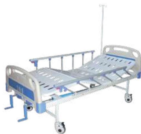
Fabriqué en tubes d'acier rectangulaire 30 x 60 mm et en tôle métallique, composé d'un dossier et plicature de genoux articulés par deux manivelles multi-positions, montants ABS, barrières de sécurité en aluminium rabattables ; une potence ; doté de quatre roues à frein de diamètre 125 mm. Peinture « époxy ».
