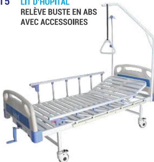
Fabriqu  en tubes d'acier rectangulaire 30 x 60 mm et en t le m tallique, compos  d'un dossier articul  par une manivelle, montants en ABS, barri res de s curit  en aluminium rabattables, une potence et un perroquet ; dot  de quatre roues   frein de diam tre 125 mm. Peinture «  poxy ».
