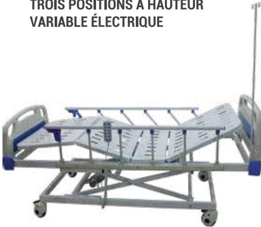
Fabriqu  en tubes d'acier rectangulaire 30 x 60 mm et en t le m tallique, compos  d'un dossier, plicature de genoux, hauteur r glable, 3 fonctions actionn es par une t l commande (syst me  lectrique), montants ABS, barri res de s curit  en aluminium rabattables; une potence; dot  de quatre roues   frein de diam tre 125 mm. Peinture «  poxy ».
