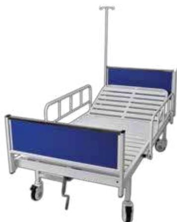
Fabriqu  en tubes d'acier rectangulaire 30 x 60 mm et t le m tallique. Compos  d'un dossier articul  par une manivelle ; montants en tube d'acier rond diam tre 32, support en m lamin , barri res de s curit  en acier rabattables ; et une potence ; dot  de quatre roues   frein de diam tre 125 mm. Peinture «  poxy ».
