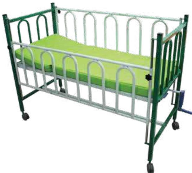
Fabriqué en tube d'acier rond de diamètre 32 et en tôle métallique, composé d'un dossier articulé par une manivelle, et d'une ridelle mouvante verticale. Il est doté de quatre roues à frein de diamètre 80 mm. Peinture « époxy ».
