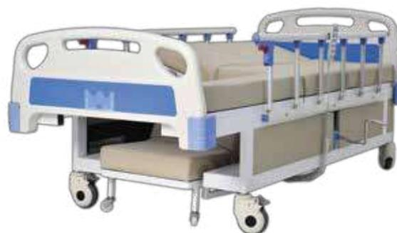
Fabriqué en tubes d'acier rectangulaire 30 x 60 mm et en tôle métallique, composé d'un relèvement buste ; positions fauteuil : 3 fonctions actionnées par une télécommande (système électrique), montants en ABS, barrières de sécurité en aluminium rabattable; partie supérieure droite inclinable par une manivelle; doté d'un matelas et de quatre roues à frein de diamètre 125 mm. Peinture « époxy ».
