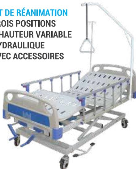
Fabriqué en tubes d'acier rectangulaire 30 x 60 mm et en tôle métallique, composé d'un dossier et plicature de genoux articulés par deux manivelles multi-positions, hauteur variable réglable par un système hydraulique, montants ABS, barrières de sécurité en aluminium rabattables; une potence; et un perroquet; doté de quatre roues à frein de diamètre 125 mm. Peinture « époxy ».
