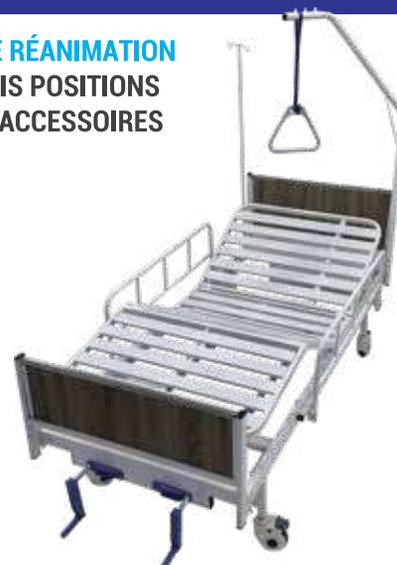
Fabriqué en tubes d'acier rectangulaire 30 x 60 mm et en tôle métallique, composé d'un dossier et plicature de genoux articulés par deux manivelles multi-positions, montants en tube d'acier rond diamètre 32, support en mélaminé, barrières de sécurité en acier rabattables; une potence; et un perroquet; doté de quatre roues à frein de diamètre 125 mm. Peinture « époxy ».
