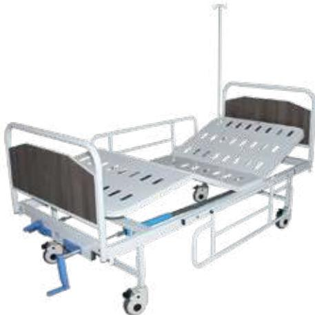
Fabriqué en tubes d'acier rectangulaire 30 x 60 mm et en tôle métallique, composé d'un dossier et plicature de genoux articulés par deux manivelles multi-positions, montants en tube d'acier rond 32 Ø, support en mélaminé, barrières de sécurité en acier rabattables; une potence; doté de quatre roues à frein de diamètre 125 mm. Peinture « époxy ».
