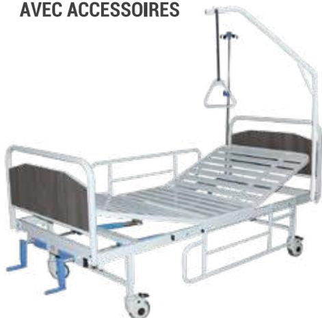
Fabriqué en tubes d'acier rectangulaire 30 x 60 mm et en tôle métallique, composé d'un dossier et relève jambes articulés par deux manivelles multi-positions, montants en tube d'acier rond diamètre 32, support en mélaminé, barrières de sécurité en acier rabattables; une potence; et un perroquet. doté de quatre roues à frein de diamètre 125 mm. Peinture « époxy ».
