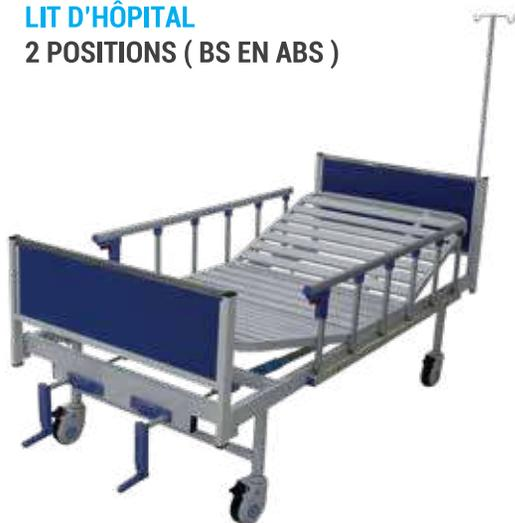
Fabriqué en tubes d'acier rectangulaire 30 x 60 mm et en tôle métallique, composé d'un dossier et relève jambes articulées par deux manivelles multi-positions, montants en tube d'acier rond 32 Ø, support en mélaminé, barrières de sécurité en aluminium rabattables ; une potence ; doté de quatre roues à frein de diamètre 125 mm. Peinture « époxy ».
