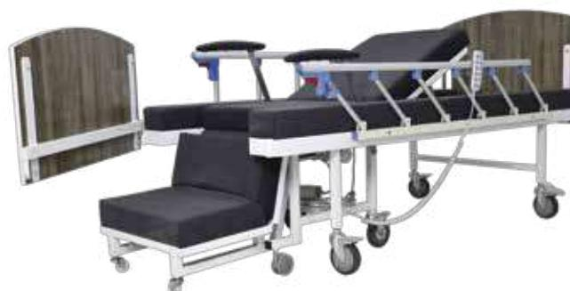
Fabriqué en tubes d'acier rectangulaire 30 x 60 mm et en tôle métallique, composé d'un relève buste; positions fauteuil : 3 fonctions actionnées par une télécommande (système électrique), montants en mélaminé, barrières de sécurité en aluminium rabattable;fauteuil détachable du lit ; doté de quatre roues à frein de diamètre 125 mm. Peinture « époxy »
