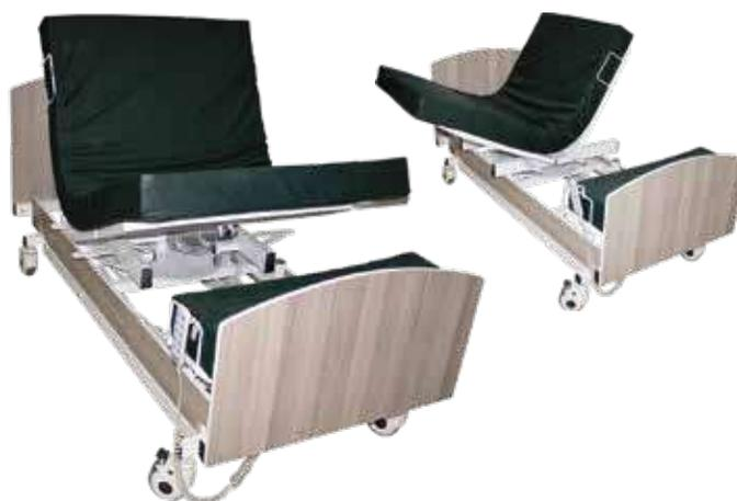
Fabriqué en tubes d'acier rectangulaire 30 x 60 mm et en tôle métallique, composé d'un relève buste, relève jambes, hauteur variable, rotation a droite ; positions fauteuil : 6 fonctions actionnées par une télécommande (système électrique), montants en mélaminé, barrières de sécurité en acier démontables ; doté de quatre roues à frein de diamètre 125 mm. Peinture « époxy ».
