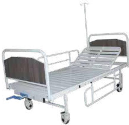
Fabriqué en tubes d'acier rectangulaire 30 x 60 mm et en tôle métallique, composé d'un dossier articulé par une manivelle, de montants en tube d'acier rond diamètre 32, support en mélaminé, barrières de sécurité en acier rabattables, une potence; doté de quatre roues à frein de diamètre 125 mm. Peinture « époxy ».
