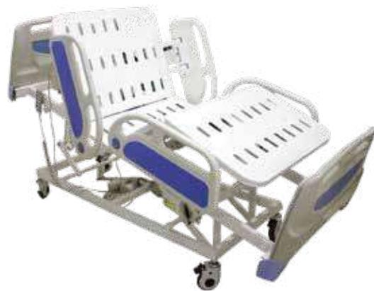
Fabriqu  en tubes d'acier rectangulaire 30 x 60 mm et en t le m tallique, compos  de : rel ve buste, plicature de genoux, hauteur variable, proclive, d clive : 5 fonctions actionn es par une t l commande (syst me  lectrique), montants ABS, 4 barri res de s curit  en ABS rabattables ; une potence; dot  de quatre roues   frein de diam tre 125 mm. Peinture «  poxy ».
