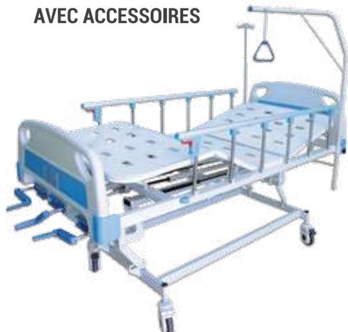
Fabriqué en tubes d'acier rectangulaire 30 x 60 mm et en tôle métallique, composé d'un dossier et plicature de genoux articulés par deux manivelles multi-positions, hauteur variable réglable par manivelle, montants ABS, barrières de sécurité en aluminium rabattables; une potence; et un perroquets; doté de quatre roues à frein de diamètre 125 mm. Peinture « époxy ».
