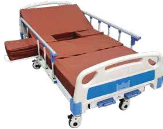
Fabriqué en tube d'acier rectangulaire et tôle métallique, composé d'un relève buste et plicature de genoux articulés par deux manivelles multi-positions, avec matelas articulé et pot de chambre en inox, de montants en ABS, barrières de sécurité en aluminium rabattable, et de quatre roues avec frein de diamètre 125 mm. Peinture « époxy ».
