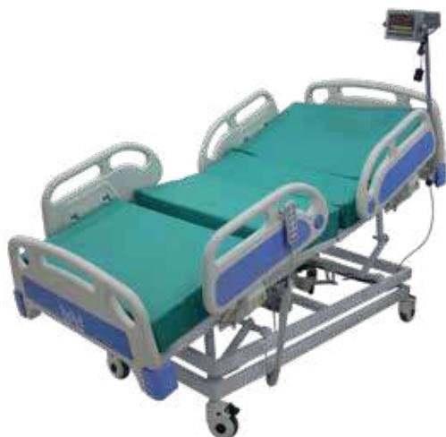
Fabriqué en tubes d'acier rectangulaire 30 x 60 mm et en tôle métallique, composé de : relève buste, plicature de genoux, hauteur variable, proclive, décline : 5 fonctions actionnées par une télécommande (système électrique), montants ABS. 4 barrières de sécurité en ABS rabattables ; une potence ; doté de quatre roues à frein de diamètre 125 mm avec pèse. Peinture « époxy ».
