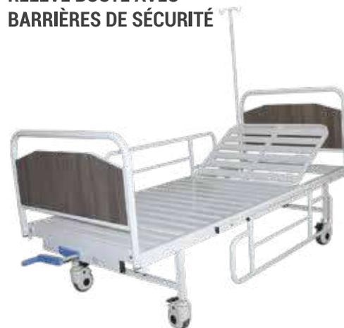
Fabriqué en tubes d'acier rectangulaire 30 x 60 mm et tôle métallique, composé d'un dossier articulé par une manivelle ; montants en tube d'acier rond, support en mélaminé, articulé par une manivelle ; montants en tube d'acier rond, support en mélaminé, barrières de sécurité en acier rabattables ; et une potence ; doté de quatre roues à frein de diamètre 125 mm. Peinture « époxy »
